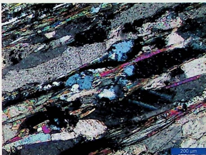
Fotomicrografia 26: (C-580 B) Porfiroblasto de quartzo com zonas de sombra de pressão de biotita e clorita. Destaque para os ribbons de calcita. Polarizadores cruzados.
