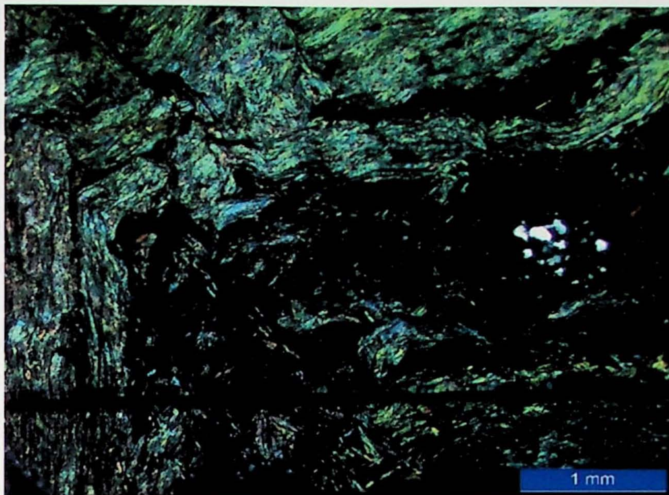
Fotomicrografia 36: (C-577) Banda granoblástica de granulação muito fina e inequigranular desenvolvida em zona axial de microdobra. Polarizadores cruzados.
