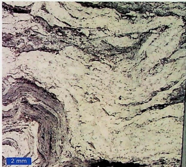
Fotomicrografia 33: (C-574-2) Figura de interferência em laço (tipo 3) com plano axial da D2 dobrado por D3. Polarizadores paralelos.
