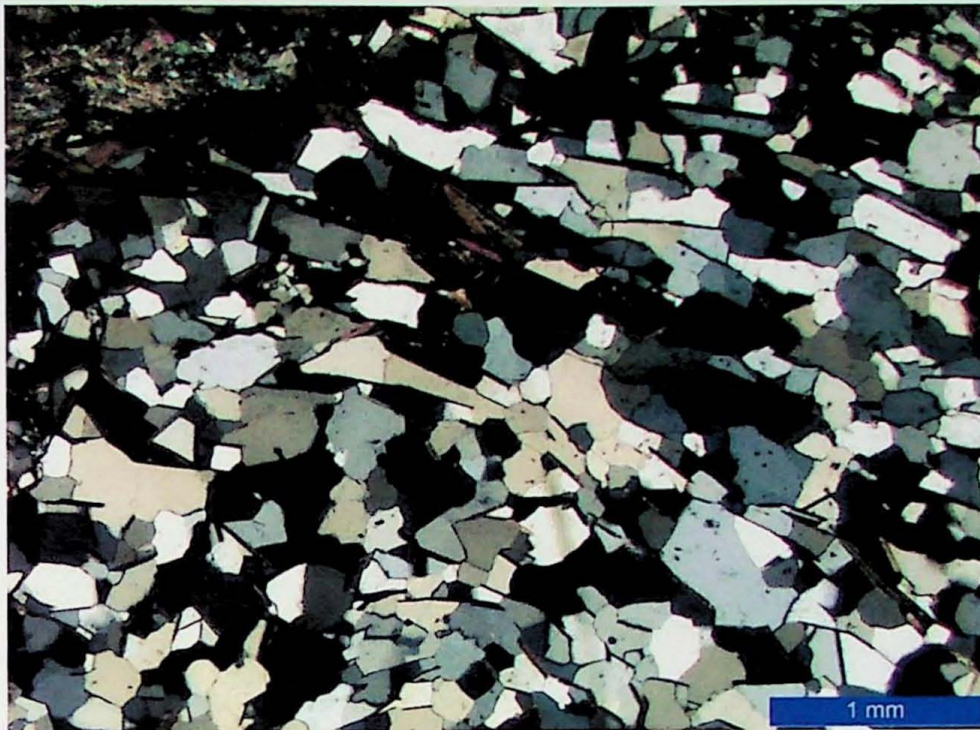
Fotomicrografia 30: (C-576 A) Ribbons de quartzo delimitados por filetes de biotita demarcando a foliação S2. Polarizadores cruzados.
