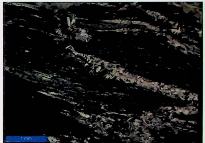
Fotomicrografia 16: (C-612 A) Bandas lepidoblásticas de muscovita e grafita com foliação sigmoidal anastomosada e formação de bandas extensionais de cisalhamento (par S-C'). Ocorrem, de forma abundante, cristais de muscovita pós-cinemática. Polarizadores paralelos.
