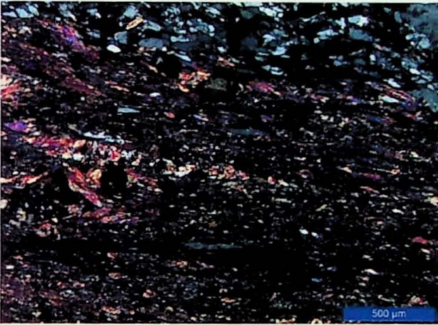
Fotomicrografia 9: (C-584 B) Porfiroblasto de epidoto com corona de zoisita e sombra de pressão de muscovita sin-cinemática, em banda lepidoblástica de muscovita e grafita. Polarizadores cruzados.
