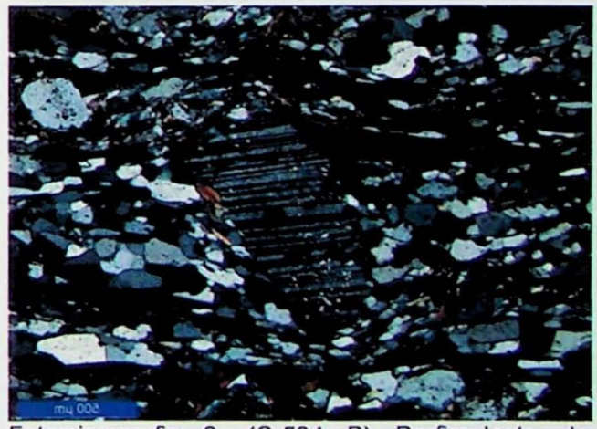
Fotomicrografia 6: (C-584 B) Porfiroclasto de plagioclásio com movimentação anti-horária, no sentido contrário ao da lineação de estiramento mineral obtida em campo. Polarizadores cruzados.
