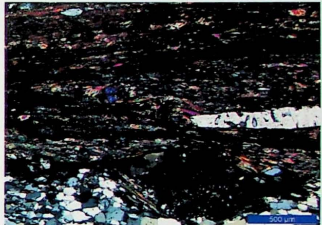
Fotomicrografia 10: (C-584 A) Porfiroblasto de epidoto com extinção anômala e sombra de pressão de muscovita em banda lepidoblástica. Polarizadores cruzados.
