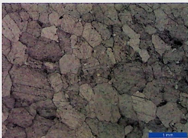
Fotomicrografia 27: (C-604 A) Cristais de carbonato (calcita ou dolomita) de contatos interlobados formando textura granoblástica e cristais finos de quartzo. Polarizadores paralelos.
