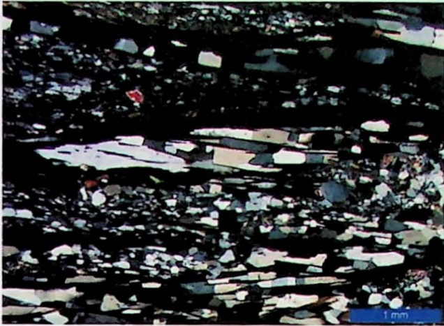
Fotomicrografia 1: (C-572-4) Ribbons de quartzo delimitados por cristais estirados de biotita e clorita intercalados por bandas de quartzo de granulação mais fina.
